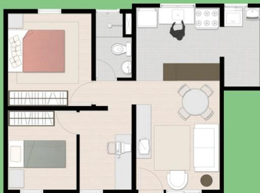
*Apartamento de paredes em alvenaria estrutural que contempla a adição de paredes que de um dos quartos em 2 ambientes, ou que separe a sala e a cozinha.*
