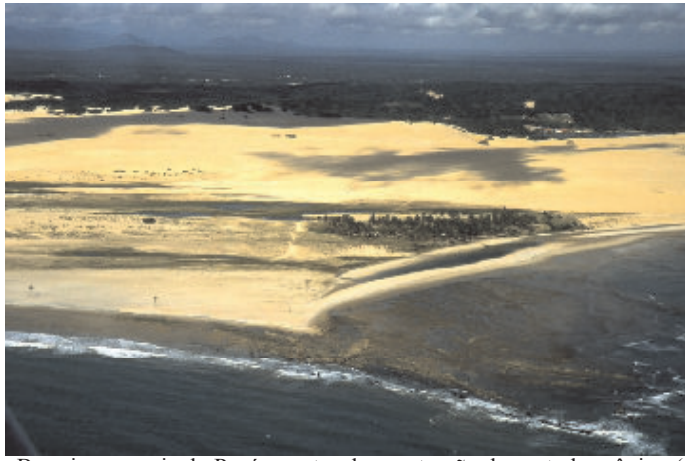
Figura III.43 – Barreira na praia do Pecém, antes da construção do porto homônimo(1996). Essa form foi destruída com a construção do porto e reapareceu anos após, o que comprova o acúmulo de sedimentos em torno das estruturas portuárias e a consequente erosão a sotomar da área (foto J.-P. Peulvast).
